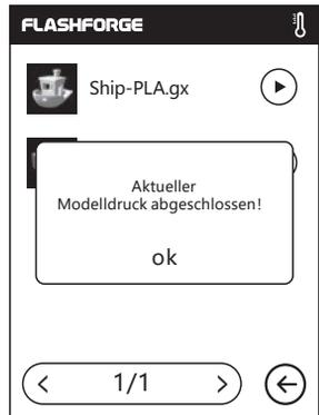
3. Der Extruder wärmt sich automatisch auf. Sobald die Aufwärmtemperatur erreicht ist, beginnt der Drucker mit dem Aufbau des Modells. Nach dem Abschluss des Druckvorgangs, gibt der Drucker einen Piepton aus und am Touchscreen wird eine Meldung angezeigt.
