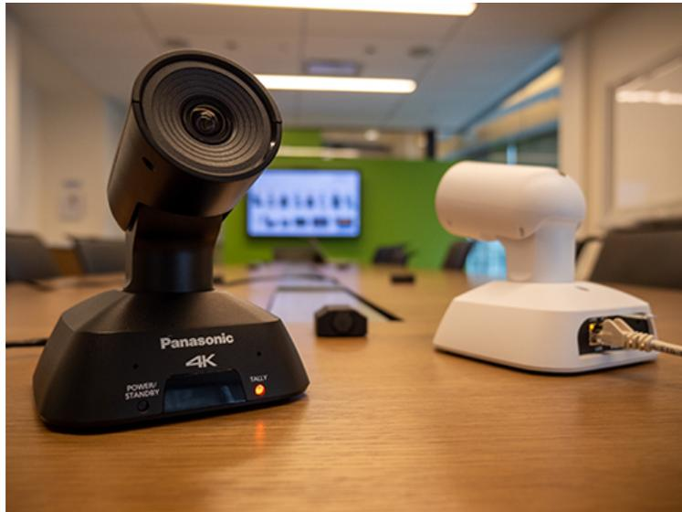
Das Gerät unterstützt PoE\* und kann auch als USB-Kamera über einen Computer gesteuert werden. Videoübertragung, Kamerasteuerung und Stromversorgung sind daher über ein einziges Kabel möglich.
